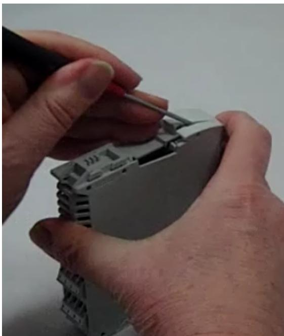
Die Gehäusehälften sind mit einer Anzahl von Raststiften zusammen gehalten. Hebeln Sie diese mit einem Schraubendreher auf.
